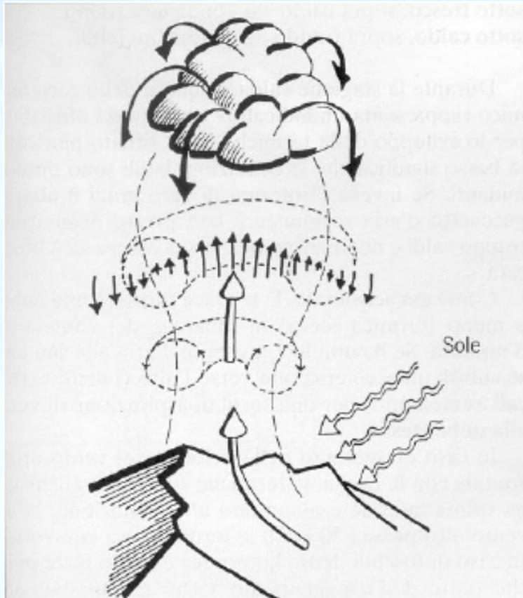
Moto ascensionale di aria calda circondata da aria più fresca. Il buco che si crea quando una bolla d'aria calda si alza richiama aria dai dintorni, la quale a sua volta deve essere rimpiazzata  $\Rightarrow$  moto convettivo, in cui colonne d'aria discendenti circondano la colonna ascendente
